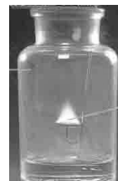
ស្ពាន់ដែរចូលផ្សំជាមួយអុកស៊ីសែន ពេលវ៉ានេះ
